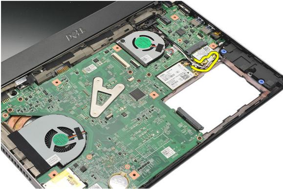
8. WLAN 카드를 시스템 보드에 고정시키는 나사를 제거합니다.
